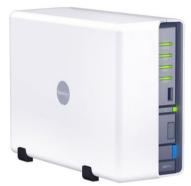
Les constructeurs spécialisés dans le NAS (Synology, Qnap, Thecus, et maintenant Asustor) et les périphériques réseau (D-Link, Netgear...) se sont spécialisés dans les barebones. Ici, le boîtier est vide : vous devez donc y installer vos propres disques avant de l'utiliser. La prix finale s'en voit augmenté, mais ces NAS sont souvent plus aboutis - notamment sur l'aspect logiciel - et donc plus polyvalents.
