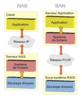
L'architecture du NAS est séparée entre : d'une part les clients, et d'autre part le serveur NAS qui gère le stockage depuis le système de fichier jusqu'aux disques. Le client n'a donc pas de connaissance de ces éléments. Dans l'architecture SAN, la gestion du système de fichier revient au serveur d'application, qui verra les volumes SAN comme étant les siens. Les protocoles de communications utilisées sont souvent SCSI sur FC pour les échanges de données, et IP sur FC pour la communication.
